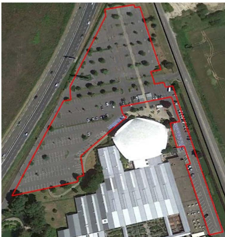
Figure 5 : potentiel d'implantation de panneaux PV en ombrière sur la zone du centre commercial MODO
